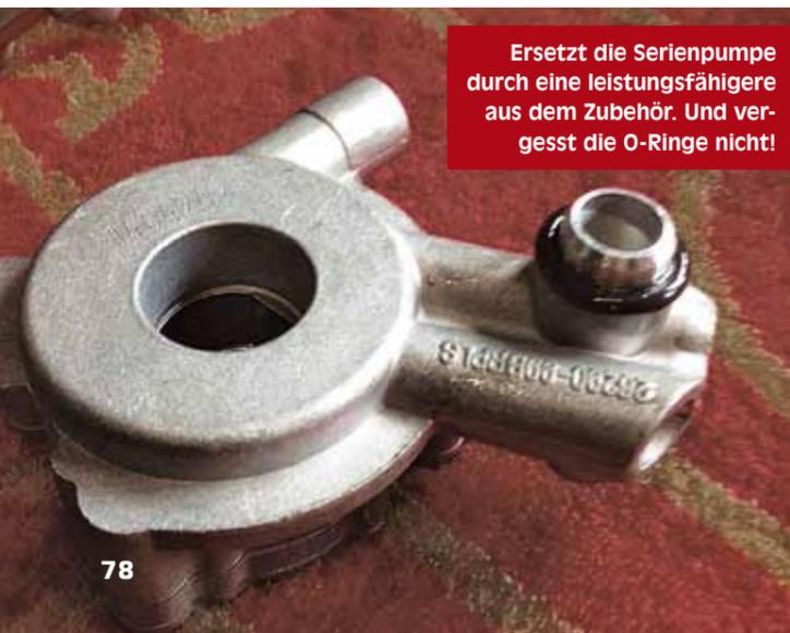
Ersetzt die Serienpumpe durch eine leistungsfähigere aus dem Zubehör. Und vergesst die O-Ringe nicht!
