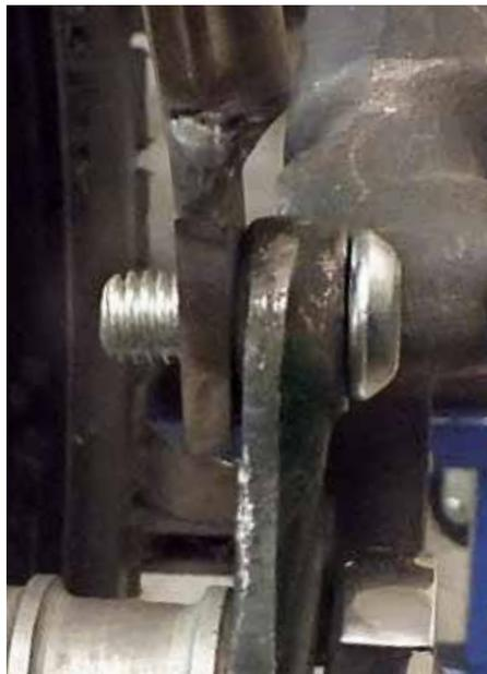
**Die Befestigung der Sissybar ist mindestens genauso wichtig, wie ihre Form. »Wer als Befestigungen Muttern an der Sissy anschweißt, outet sich gleich als Null.« Also strengt euch an, Sissy hat's verdient**
