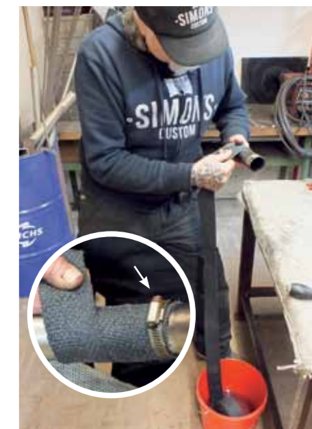
Fixiert den Wickelanfang mit einer Rohrschelle und wickelt immer aus dem Eimer
