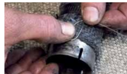
Legt eine Drahtschleife zu einer Öse und umwickelt das Band mit dem Draht
