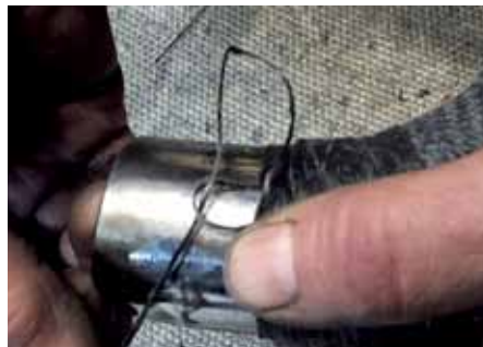
Wie bei der Drahtlösung auch, braucht ihr eine Öse zur späteren Befestigung
