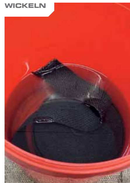
Vor Gebrauch muss das Band eingeweicht werden, so ist es leichter zu verarbeiten
