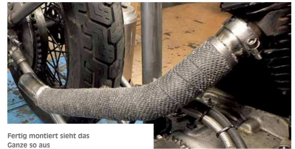
Kleiner Tipp: Verwendet flexiblen Edelstahl draht mit 0,8 mm Durchmesser
