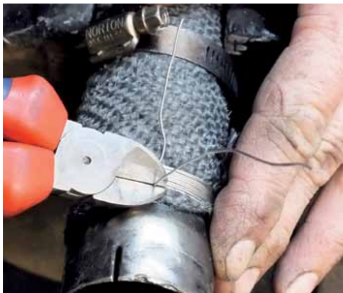
Kneift das Drahtende ab und löst die Rohrschelle
