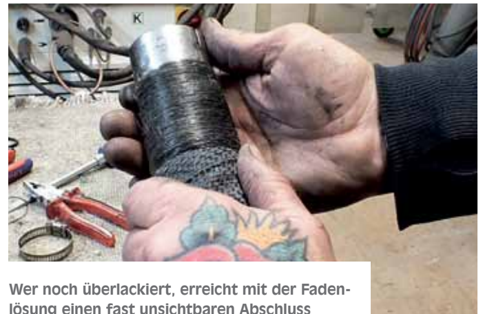
Wie bei der Drahtlösung auch, braucht ihr eine Öse zur späteren Befestigung
